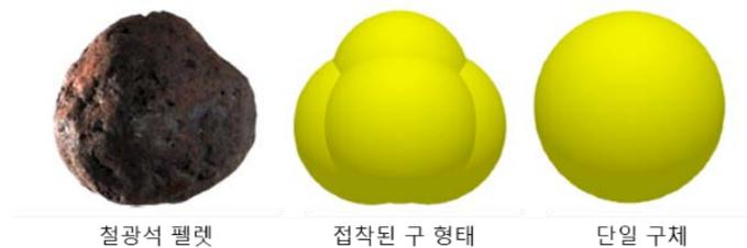
그림 III-14: ‘접착된 구’ 접근법을 이용한 철광석 펠렛 형태의 정의
